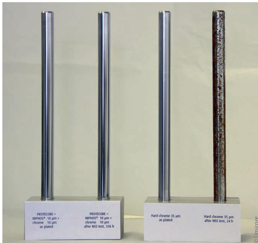
Das zweilagige Schichtsystem mit einer 10 µm-Basischicht aus Nickel-Phosphor-Legierungen und einer 10 µm-Chromschicht (linker Block, rechter Stab) ist nach 336 Stunden im neutralen Salzsprühnebeltest (NSS-Test) nahezu unverändert. Massive Korrosion zeigt sich dagegen bei einer 35 µm dicken Chromschicht schon nach 24 Stunden im NSS-Test.
